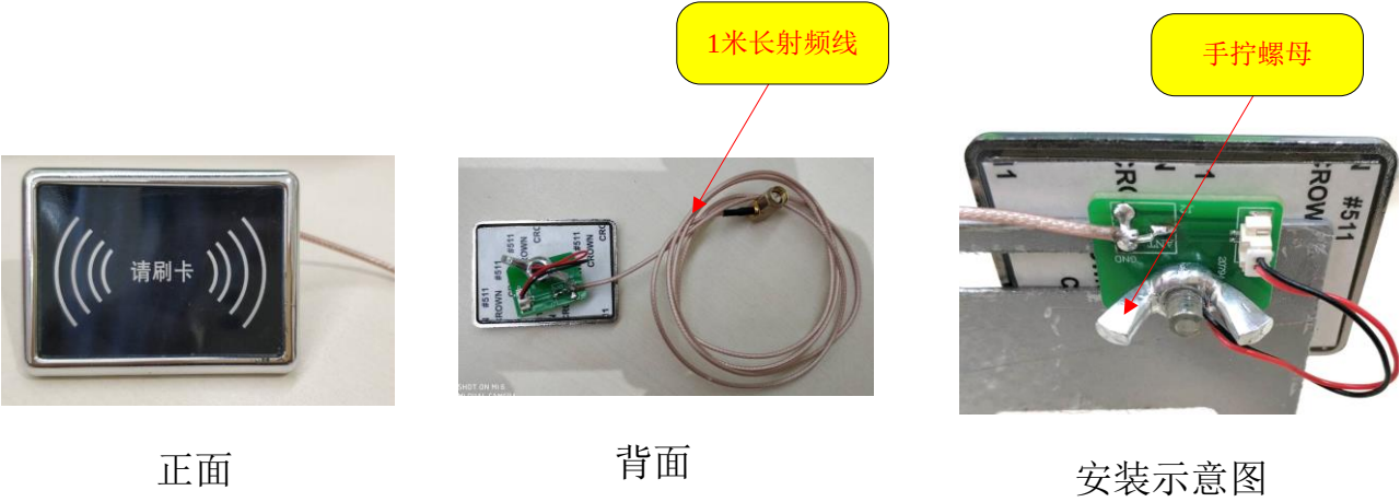
图 2.2 电梯轿厢端控制器读卡头实物图
