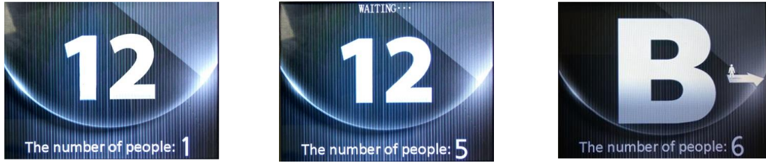
图 3.6 有人数输入模式下选层过程示意图
