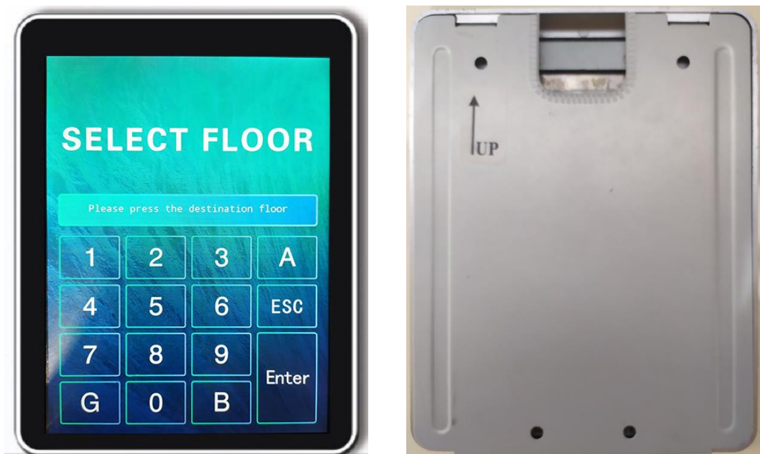
图 3.9 触摸屏目的层选层器实物图
