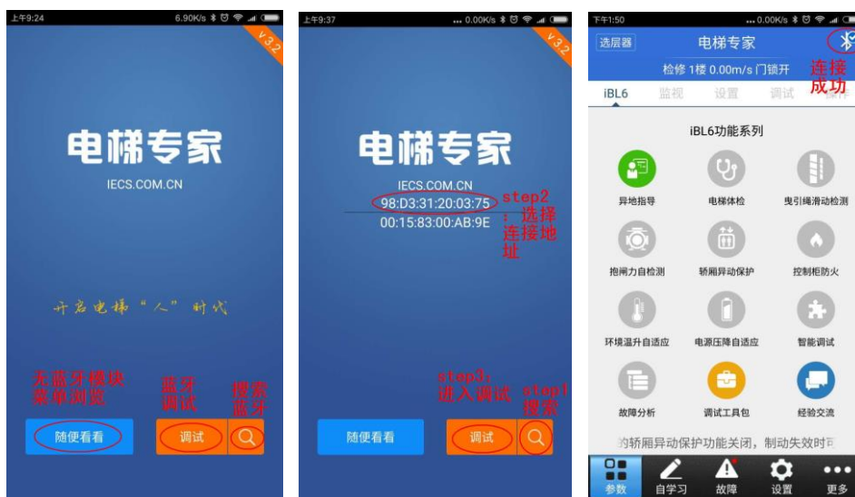
图 3 Android 版电梯专家连接示意图
