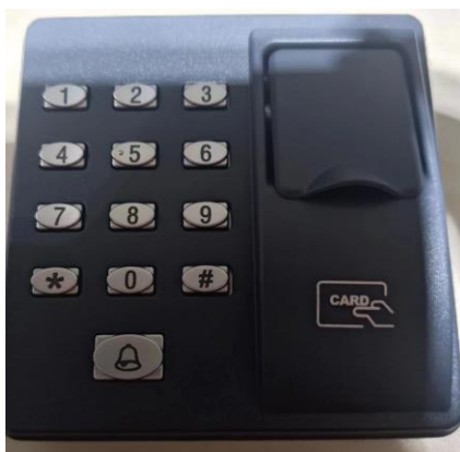
图 1 指纹刷卡密码三合一产品正面实物图
