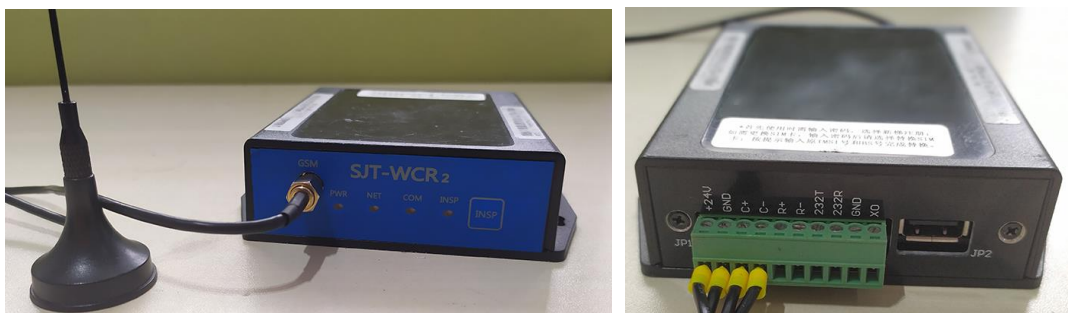
图 1.1 远程监控装置（SJT-WCR2）实物图
