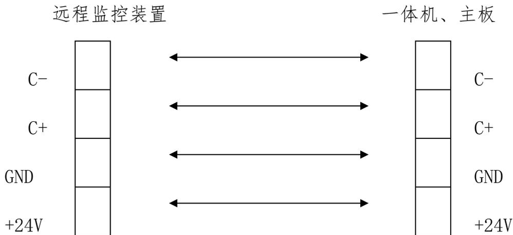
图 1.1 远程监控装置与电梯控制系统接线示意图
