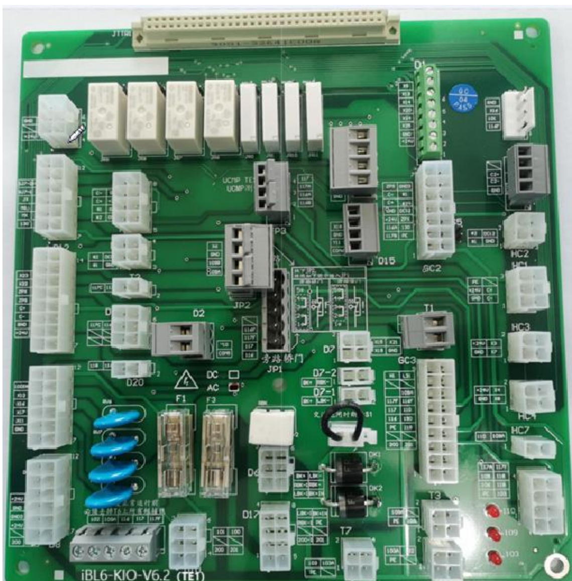
图 11.1 iBL6-KIO-V6.2 控制柜接口板实物图
